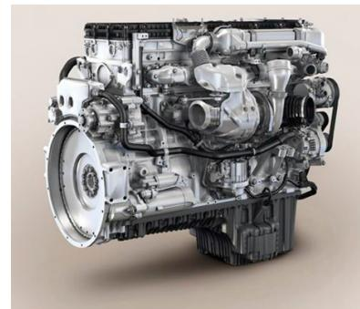
Das neue Einmotorenkonzept des GMK4080-2, mit modernster Euromot 4/Tier 4 final Motortechnologie verringert den Kraftstoffverbrauch auf ein Minimum. Durch den ECO-Mode erreicht der GMK4080-2 den geringsten Verbrauch seiner Klasse.
